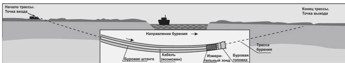
Рисунок 8.3 - Направленное бурение пилотной скважины
