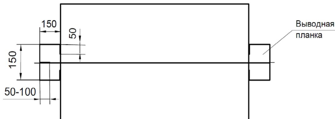
Рисунок 10.2.1 - Схема приварки выводных планок
