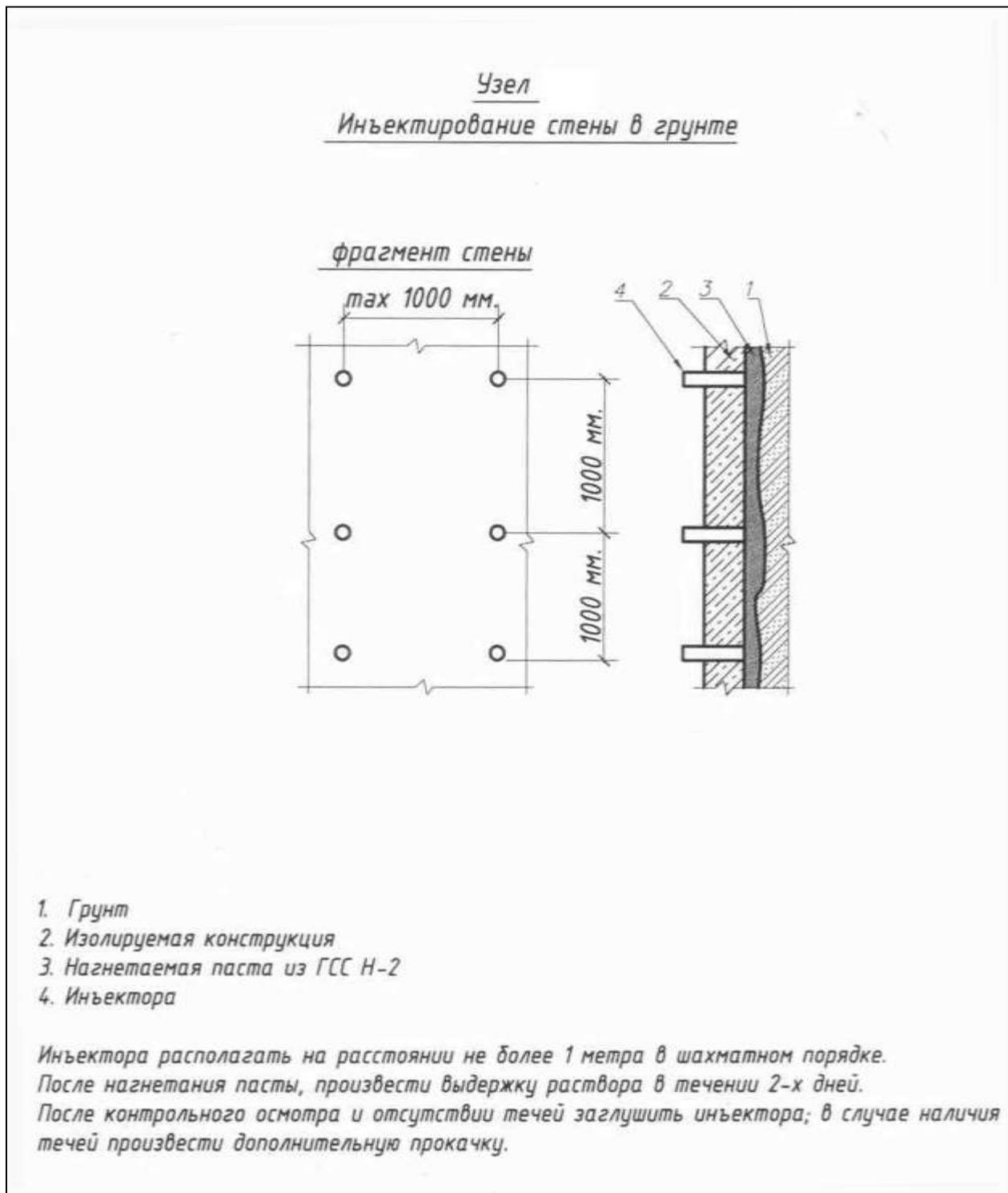
Рисунок Г.2 – Узел гидроизоляция стены инъектированием при ремонте
