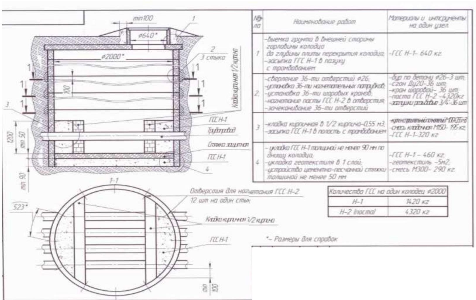
Рисунок Г.10 – Узлы гидроизоляции колодца при ремонте
